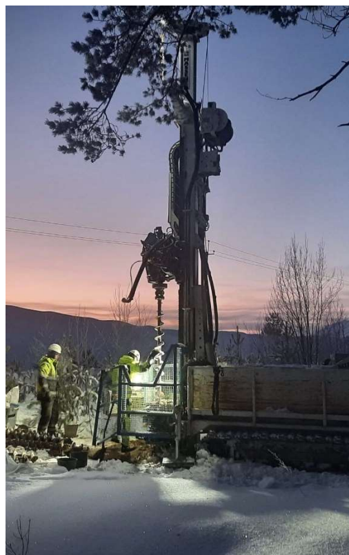
Foto 4.2. Puurauk Pa-1 puurimine Pannjärve uuringuruumis (foto M. Karimov, 11.01.2022. a, N 59°17'01" ja E 27°34'01")
